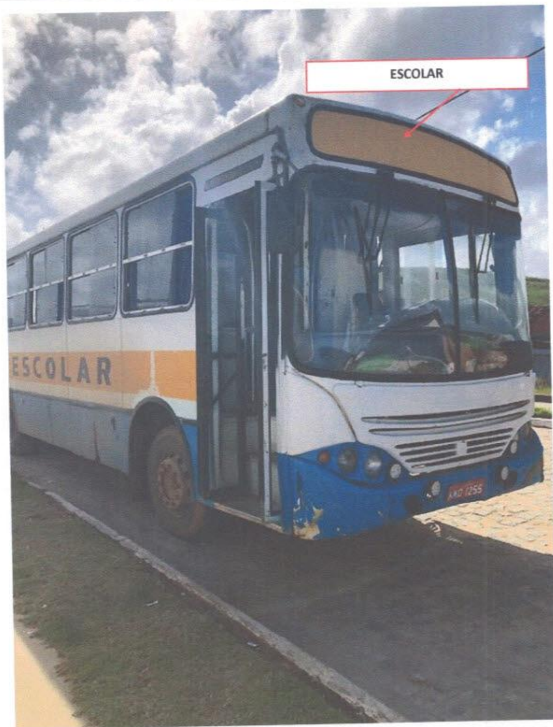
Veículo sem identificação de ESCOLAR na parte superior da frente
