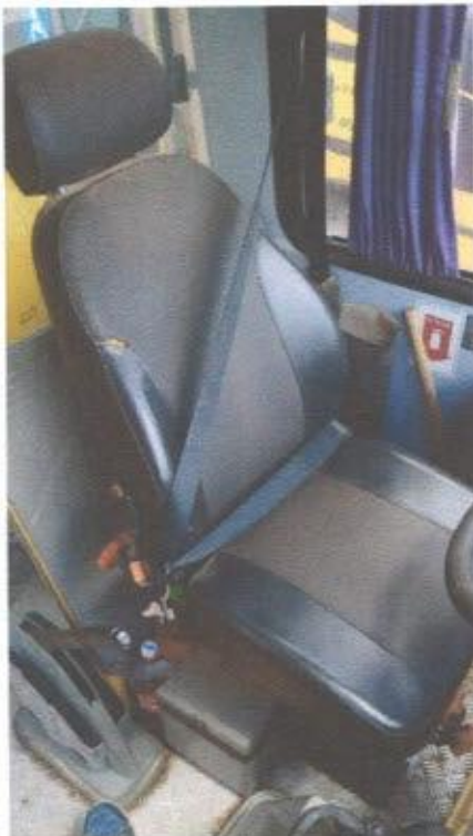
Cinto de Segurança (motorista) em perfeitas condições de uso
