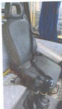
Foto 28 – Veículo com cinto de segurança (motorista) danificado. Placa PEP-2444 (Art. 136, VI da Lei 9.503/1997). Água Preta/PE. Foto em 11/12/2018.
