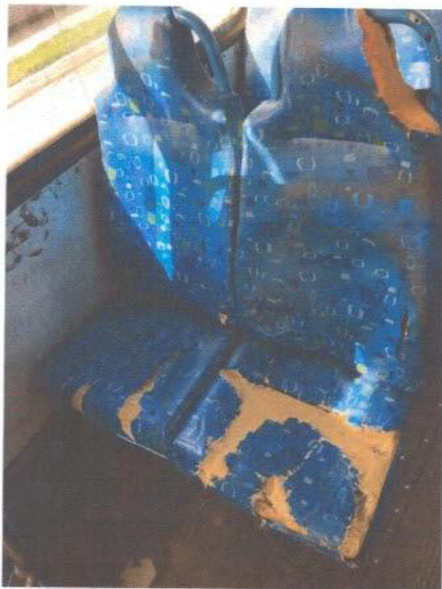
Assentos deteriorados e sem cintos de segurança
